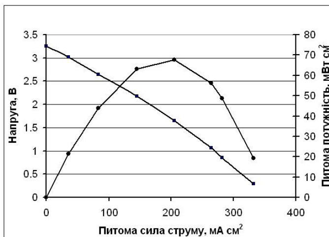
Рис. 13. Вольт-амперна характеристика роботи батареї паливних комірок при 600 °С
