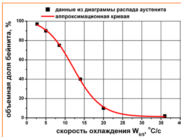
Рис. 8. Залежність об'ємної частки бейніта від швидкості охолодження в інтервалі температур 600-500°C
