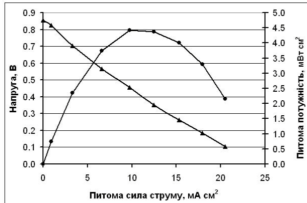
Рис. 12. Вольтамперні характеристики роботи однієї паливної комірки при 600 °С
