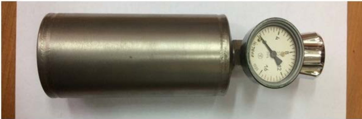
Рис. 16 – Сосуд високого тиску накопичувача водню
