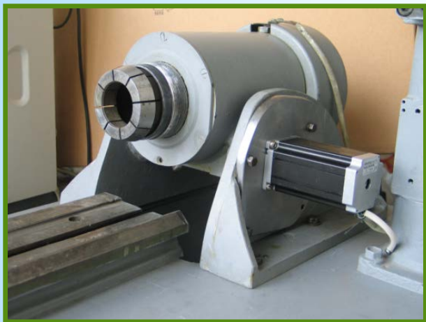
Макет передньої бабки з електроприводом (кроковий електродвигун)
