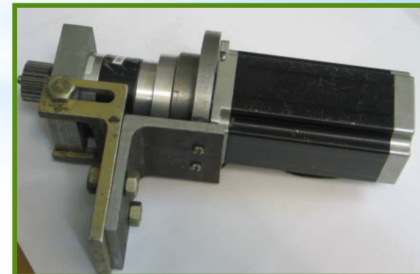
Макет механізму поперечного переміщення укладальника волокна з електроприводом (кроковий електродвигун)
