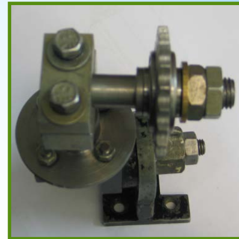
Макет механізму поздовжнього переміщення каретки з волоконним трактом, натяжним механізмом, і електроприводом (кроковий електродвигун)
