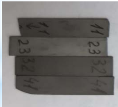
Зразки матеріалу анода після однократного відновлення у суміші Ar-5%N 2
