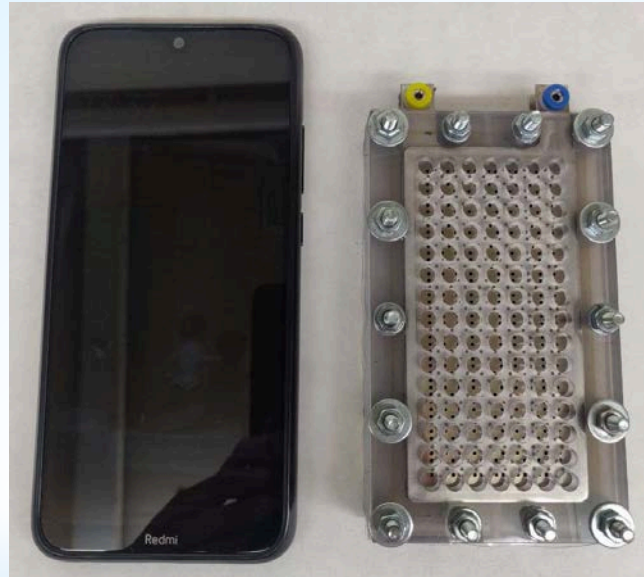
Комбінована паливна комірка для зарядного пристрою з енергоакумлюючими матеріалами (на основі алюмінію)
