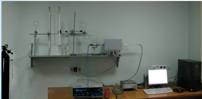
Стенд для вимiрювання iмпедансу на базi установки Solartron 1260
