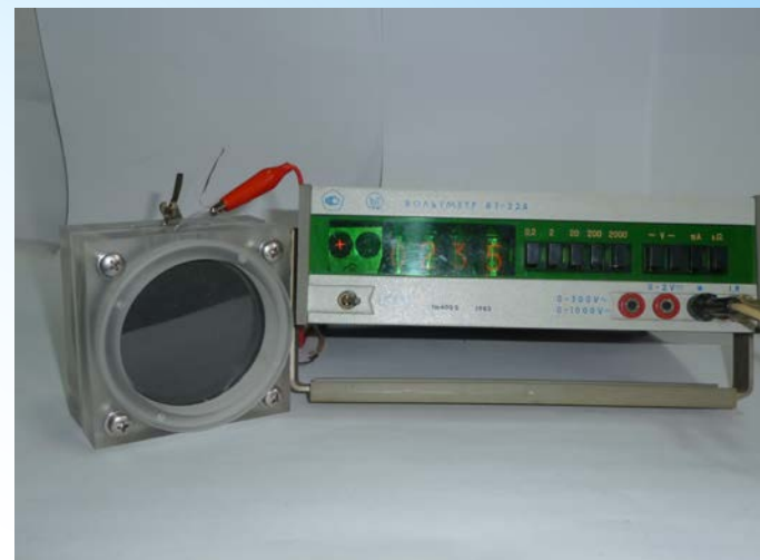
Електрохімічна паливна комірка з фотоелектродом та системою МН/повітряний електрод.
