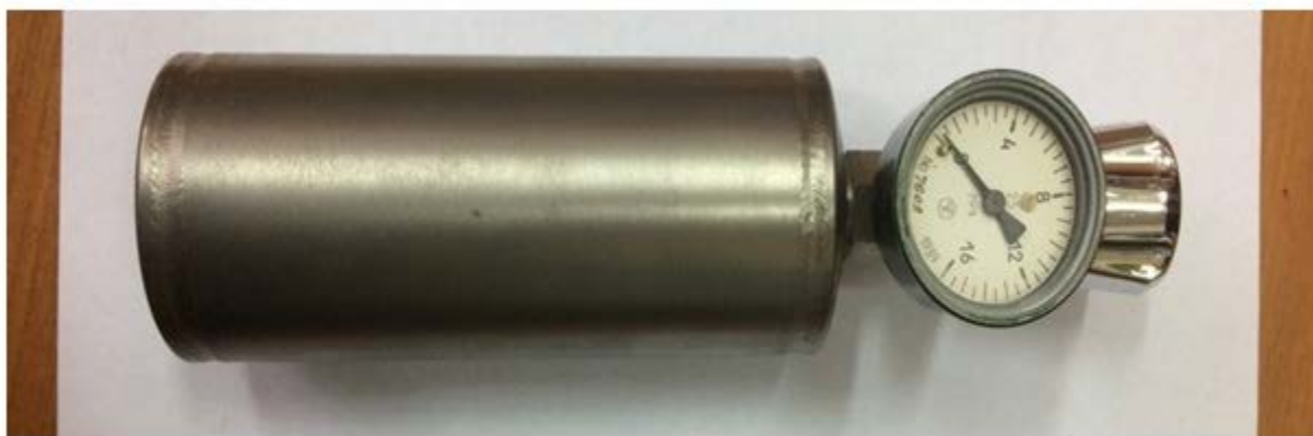
Рис. 16 – Сосуд високого тиску накопичувача водню
