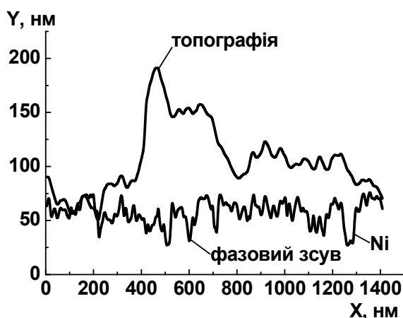
Рис. 4. Спільне зображення кривих профілю і фазового зсуву ділянки поверхні ТП після ЛО з E = 0,2 Дж
