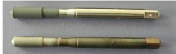
Рис.26 Заготовки свердел з функціонально –градієнтним електрофоретичним твердосплавним покриттям до і після спікання
