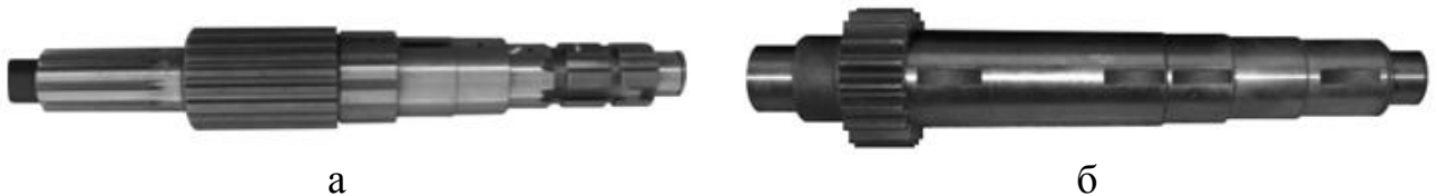
Рис. 16 Типові вироби, що відновлюються шляхом нанесення електрокристалізованого сплаву Fe-Cr-Ni – ведений (а) та проміжний (б) вали коробок передач вантажних автомобілів
