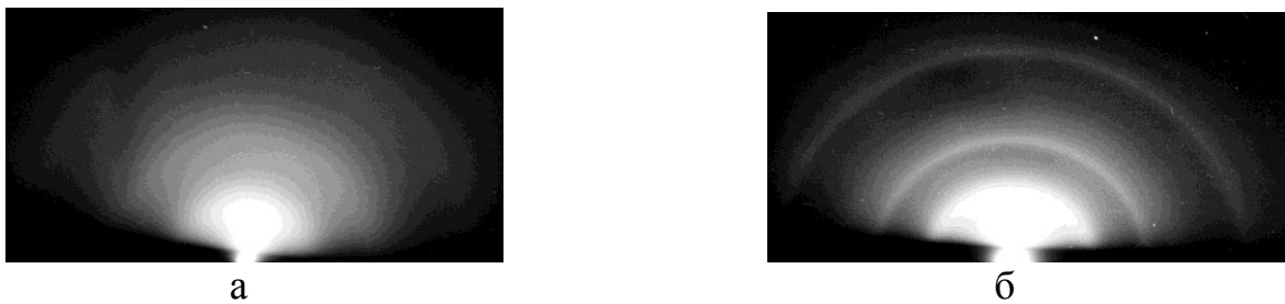
Рис.3. Електронोगрами від вуглецевих плівок, осаджених при температурах підкладки в інтервалі T_n = 20-400 °С (а) та при T_n > 500 °С (б).
