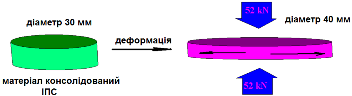
Рис. 5 - Схема проведення експерименту по деформації зразків на основі тугоплавких наноконсолідованих ІПС.
