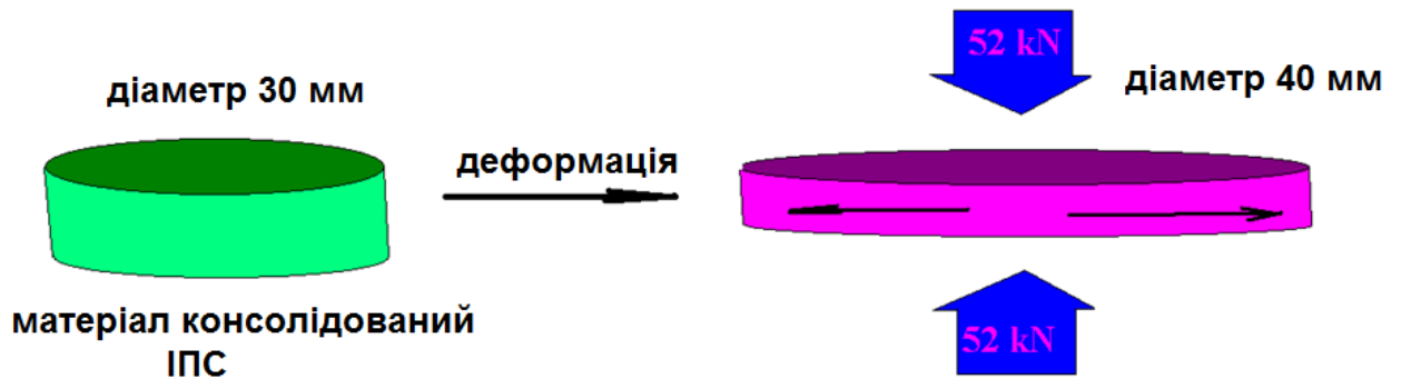
Рис. 2.15 - Схема проведення експерименту по деформації зразків на основі тугоплавких нанокompозитів
