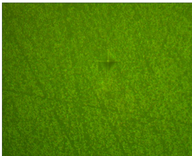
Рис. 5.20 - Фото поверхні зразка, тестованого в середовищі NaOH та відбитку індентора
