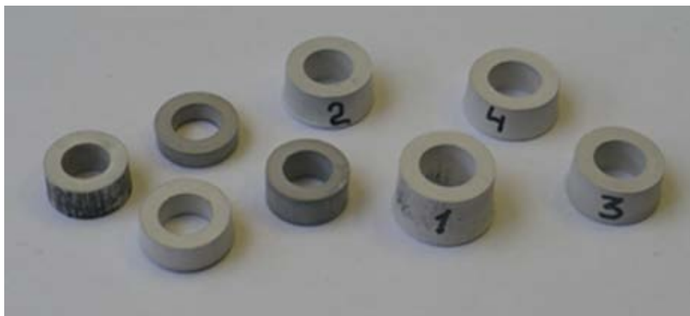
Рис. 5.5 - Загальний вигляд зразків консолідованих спіканням з контрольованою швидкістю ущільнення
