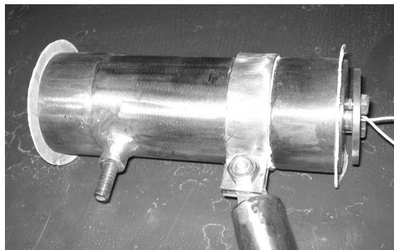
Рисунок 15 - Нагрівальний вузол повітряного стерилізатора та повітряний стерилізатор в зібраному вигляді
