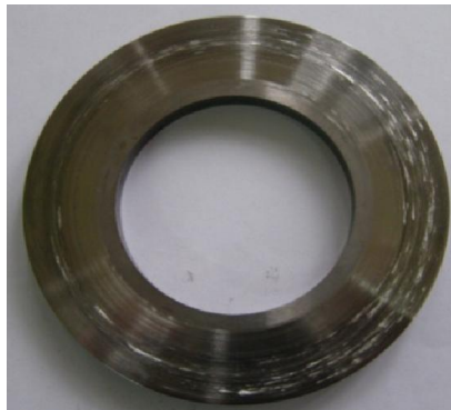
Рисунок 5.1 – Зображення поверхні контртіла зі сталі 10 після триботехнічних випробувань зразків складу 15% лігатура № 2 - 85% Al
