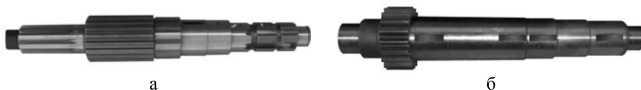
Рис. 17 Деталі вантажних автомобілів, відновлені шляхом нанесення електрокристалізованого сплаву Fe-Cr-Ni: ведений (а) та проміжний (б) вали коробок передач
