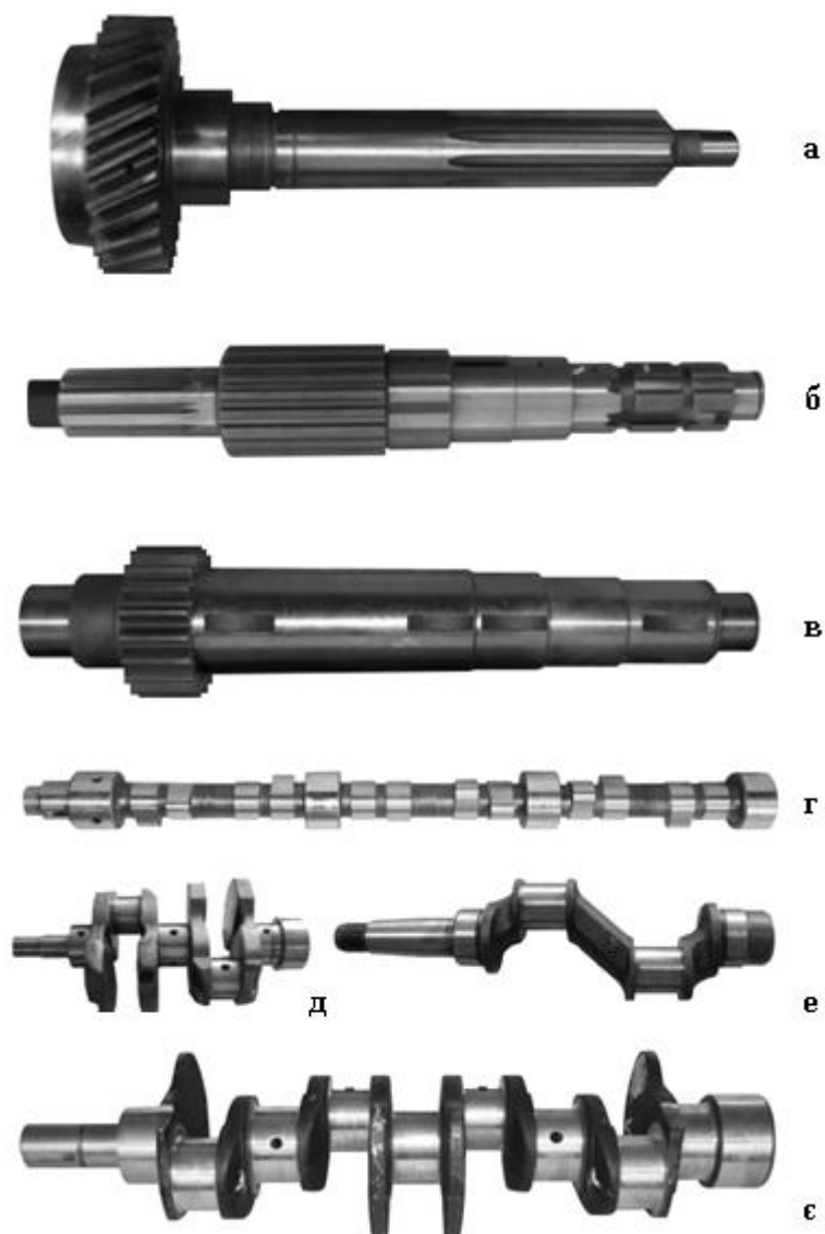
Рис. 7.1 Типові вали автомобільної та будівельної техніки, які відновлюються шляхом нанесення електрокристалізованого сплаву Fe-Cr-Ni: а – провідний вал коробки передач; б – ведений вал коробки передач; в – проміжний вал коробки передач; г – розподільний вал; д, е, є – колінчасті вали
