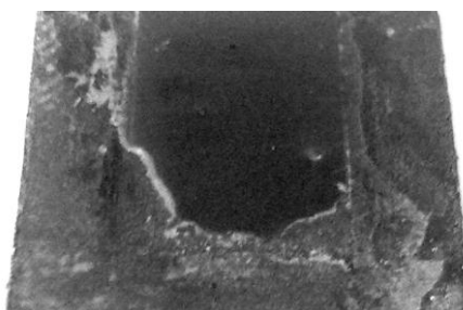
Рис. 7.4 Когезійний характер руйнування покриття полі-м-,п-феніленізофталамідом (80 мкм) при відшаруванні від електрокристалізованого сплаву Fe-Zn, одержаного з електроліту з концентрацією цинку 5 г/л
