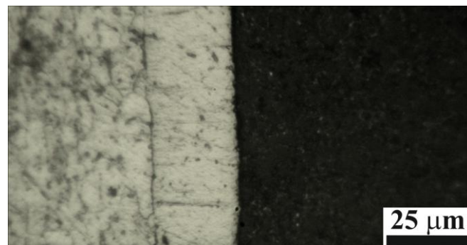
Рис. 3.24 Мікроструктура електрокристалізованого сплаву Fe-Ni, поперечний шліф
