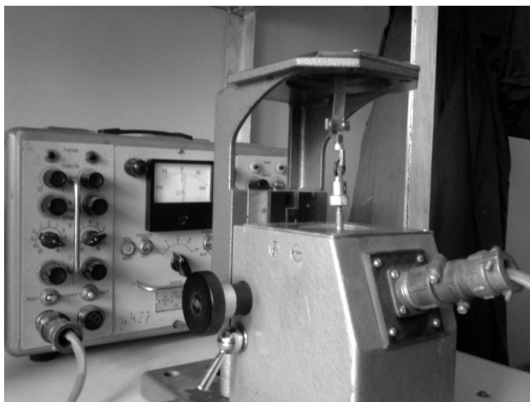
Рис. 7.3 Випробування міцності адгезійного з'єднання електрокристалізованого сплаву Fe-Zn з полі-м-,п-феніленізофталамідом на відшарування
