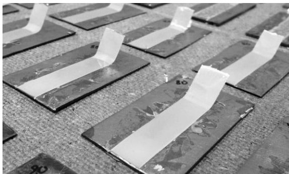
Рис. 2.16 Зразки для випробувань на відшарування полімерного покриття від металевої основи
