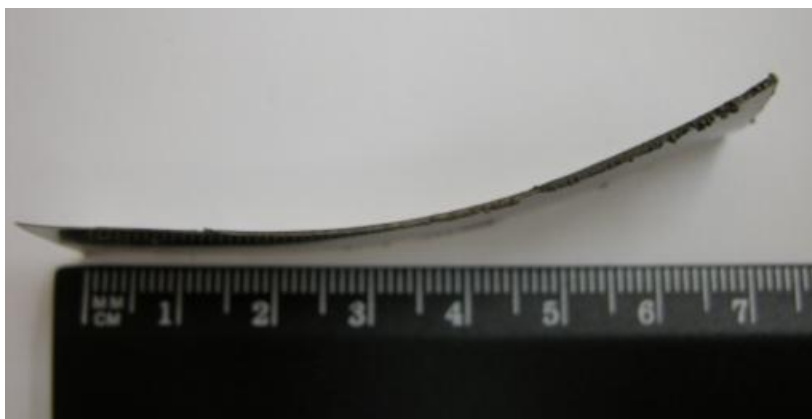
Рис. 4.33 Вигин зразка жерсті (0,25 мм) з покриттям електрокристалізованим сплавом Fe-Cr-Ni завтовшки 150 мкм внаслідок стискаючих макронапружень
