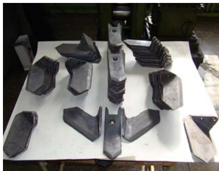
Рис. 18. Зразки розпушувачів глибокого рихлення, виготовлених з високоміцного бейнітного чавун в заміні імпортних деталей: деталі розпушувача «TIGER» (а); розпушувач культиваторів «Soil Pro» (б)
