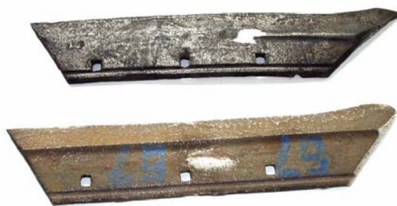
Рис. 14. Лемеші з різною конфігурацією ребра жорсткості
