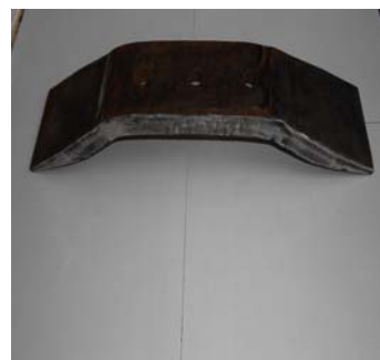
Рис. 17. Лапа до культиватора QuaadX (а), Долото до глибокорозпушувача Vogel Noot (б)
