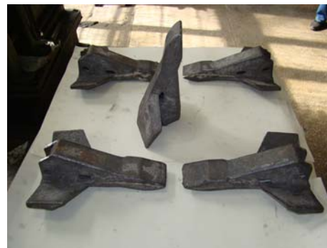
Рис. 18. Зразки розпушувачів глибокого рихлення, виготовлених з високоміцного бейнітного чавун в заміні імпортних деталей: деталі розпушувача «TIGER» (а); розпушувач культиваторів «Soil Pro» (б)
