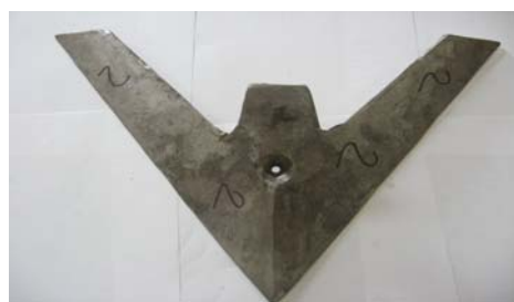
Рис. 15. Алюмінієва модель (а) та лита чавунна лапа (б)
