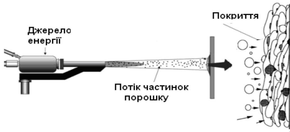
Рисунок 1.1.1 – Принципова схема нанесення покриттів методами газотермічного напилення
