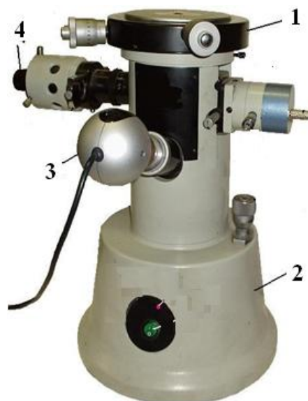
1 – предметний столик; 2 – корпус; 3 – цифрова камера; 4 – лампа
