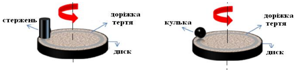
Рисунок 2.8.3 – Схема випробувань композиційних покриттів на триботестері CETR UMT Multi-Specimen Test System.
