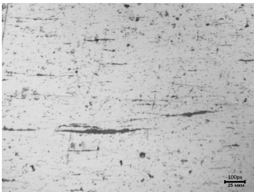
Рисунок 6.12 – Мікроструктура матеріалу Ni-20Cr-3Al-1,5Y 2 O 3 , підданого ступеню обтискання при прокатці понад 30%
