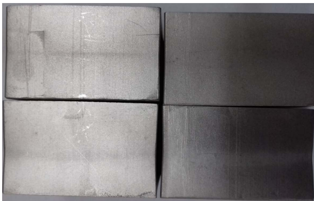
Рисунок 6.7 – Заготовки сплаву Ni-20Cr-3Al-1,5Y 2 O 3 після двократної прокатки і відпалу у вакуумній печі при 1200 0 С протягом 2-х годин
