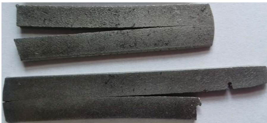
Рисунок 6.11 – Вигляд заготовок сплаву Ni-20Cr-3Al-1,5Y 2 O 3 , підданих більшому за 30 % обтисканню при прокатці
