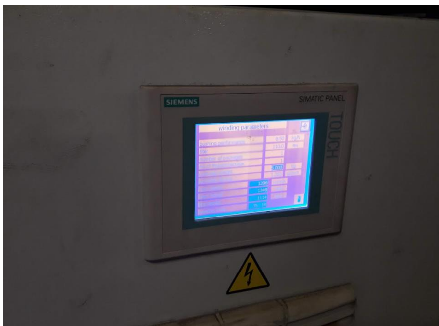
Рисунок 6.11 – Програмне забезпечення намотуючого пристрою
