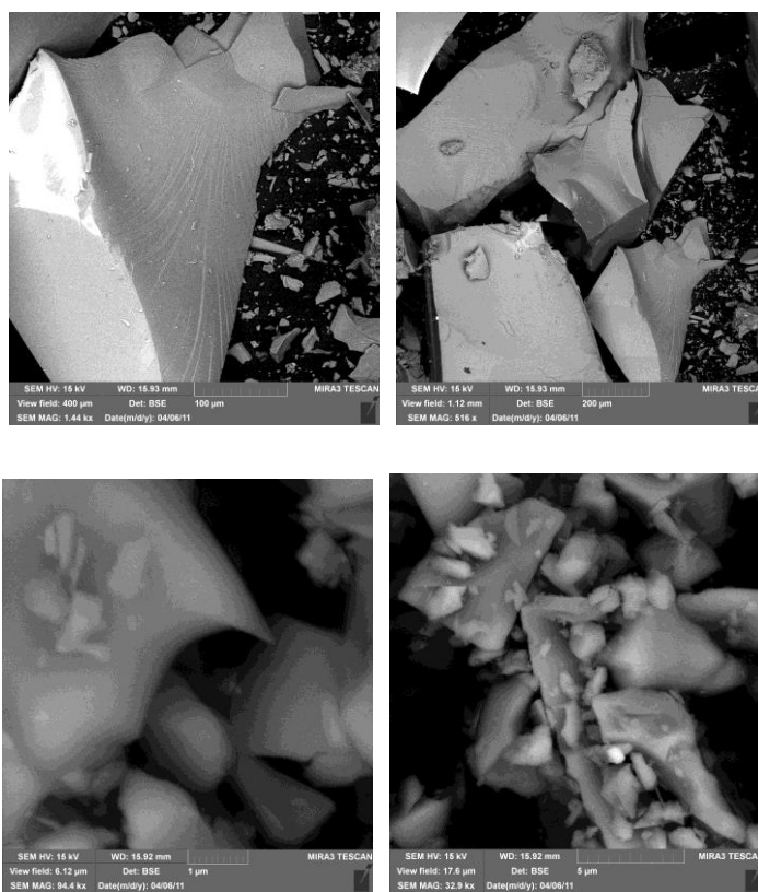
Рисунок 3.17 – SEM: а) масивного скла та б) подрібненого скла в порошок
