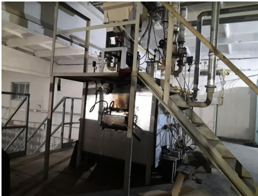
Рисунок 6.9 – Скловарна промислова піч для отримання розплавів із гірських порід
