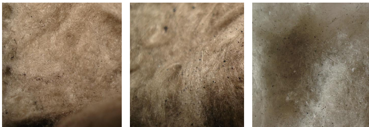
Рисунок 4.14 – Базальтові волокна модифіковані ZrO_2
