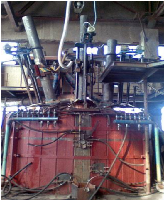
Рисунок 2.4 – Індукційна піч для плавлення гірських порід
