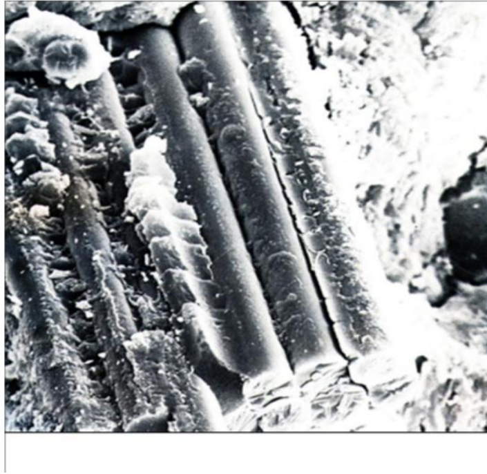
Рисунок 1.1 – Результати впливу лужного середовища на волокна з Е-скла (ліва частина) та CemFIL (права частина) [85]
