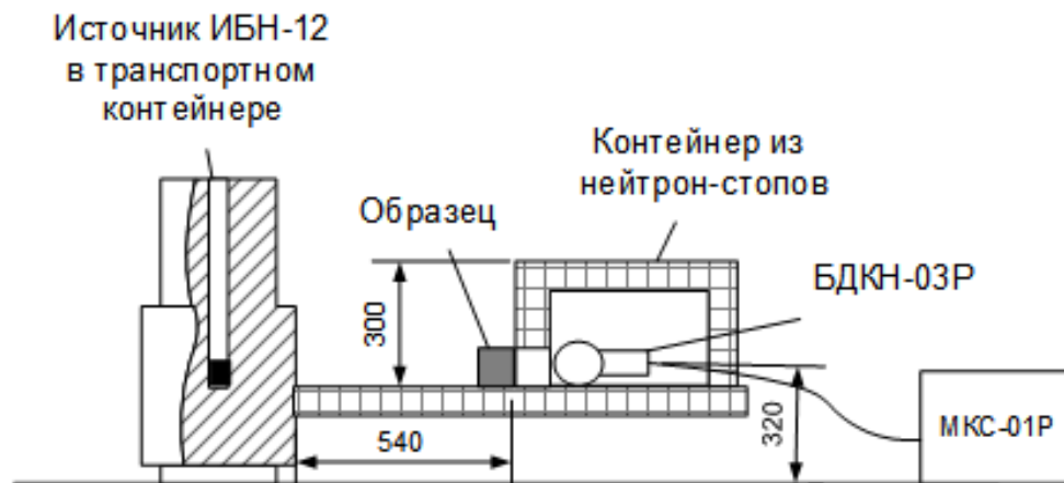
Рисунок 5.12 – Схематичне зображення геометрії вимірювання в "складному" експерименті
