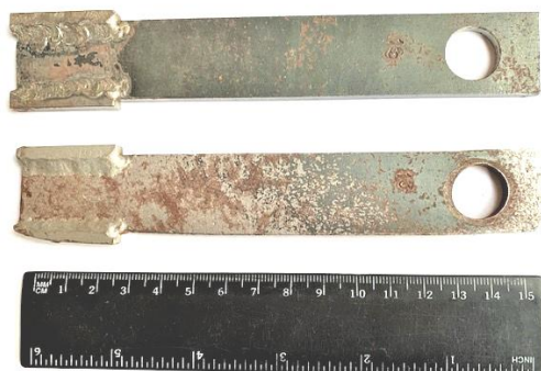
Рис. 20 - Молоток дробарки БМК–1 зі вставками із карбідосталі 65Fe–35ФХ800 (% мас.), привареними електрозварюванням (до випробувань; після виробничих випробувань)
