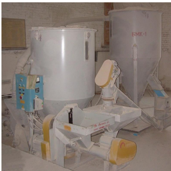
Рисунок 5.2 - Установка для приготування кормів БМК–1
