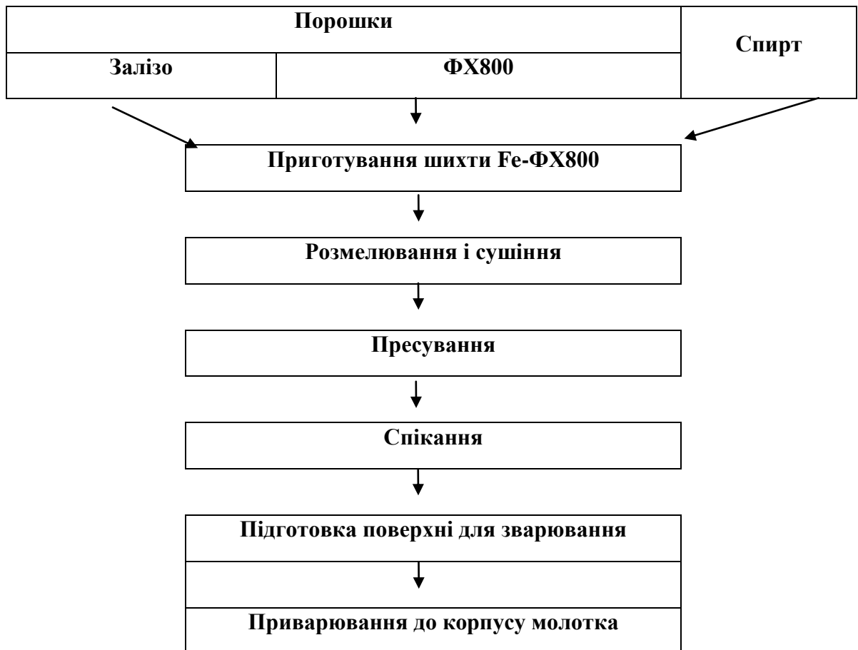
Рисунок 5.1 - Технологічна схема виготовлення зносокорозійностійких “вставок” в молотки кормодробарок
