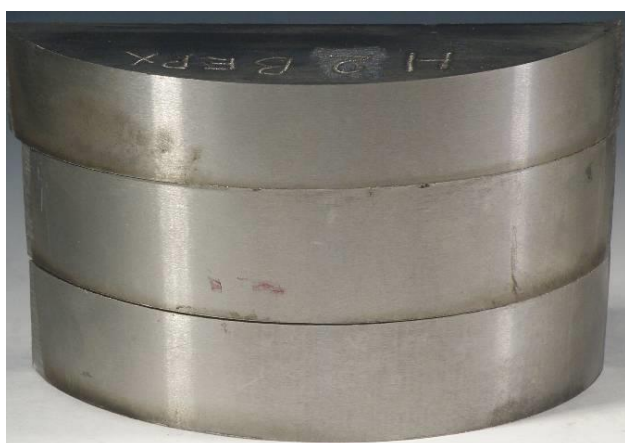
Рис. 4.11. Зовнішній вигляд поверхні зливка Ø 97 мм, отриманого з відходів сплаву ЖС26-ВИ методом ЕПП
