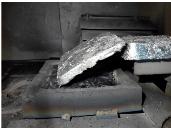
Рис. 4.2. Зовнішній вид присрою для плавки лігатур з використанням бічного механізму подачі заготовки в проміжну ємність
