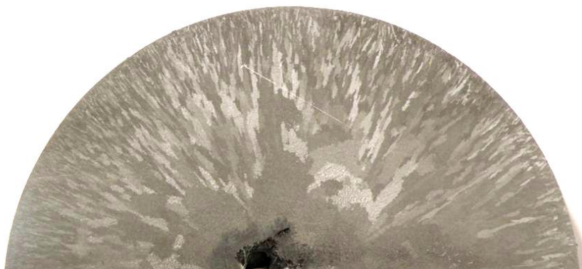
Рис. 4.13. Макроструктура в поперечному перерізі середньої частини заготовки діаметром 80 мм зі сплаву ЖС26-ВИ виробництва ВАТ «СМК»
