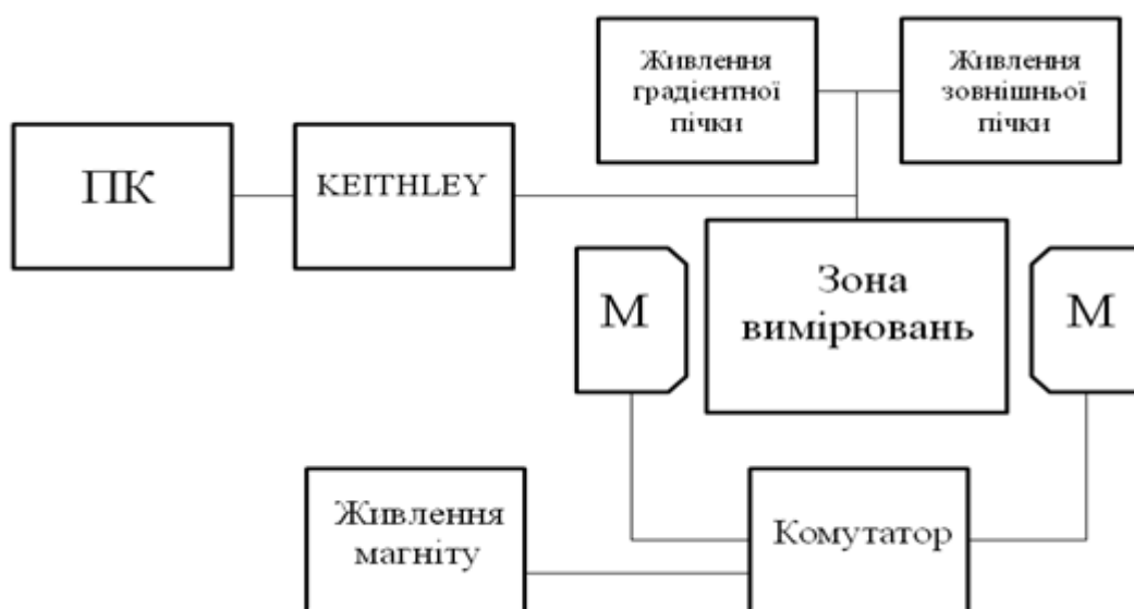
Рисунок 5.1 – Блок-схема установки автоматичного вимірювання термоерс та термоерс в магнітному полі
