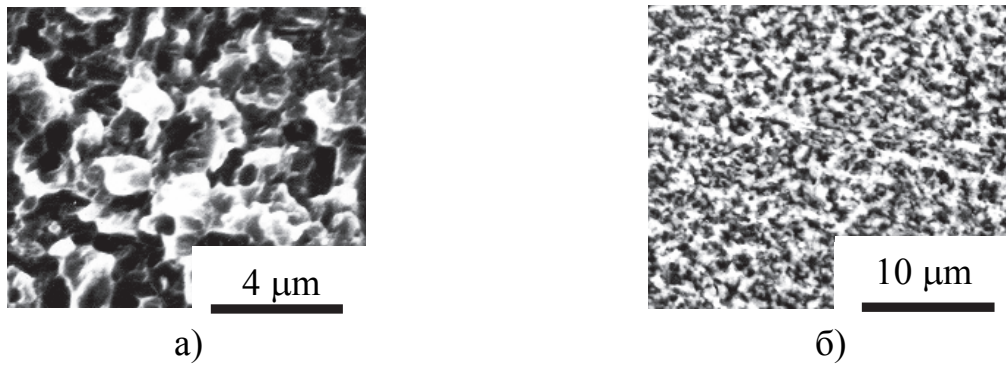
Рис. 12. Мікроструктура масивних наноструктурних зразків, SEM фотографії: а) поверхня зламу Ni; б) механічно полірована поверхня сплаву Zn-22%Al.
