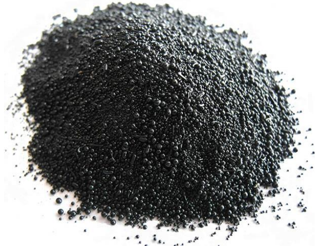
Рис. 9 – Несортовані за розміром та формою базальтові мікросфери, виготовленні методом індукційної плавки.
