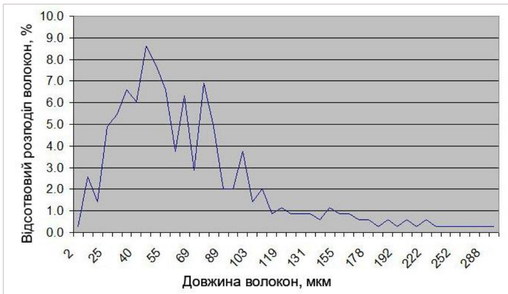
Рис. 8 – Характерний розподіл елементарних волокон за довжиною. Середнє значення довжини волокон 70 мікрон, максимум функції розподілу фібри за довжиною зосереджений у районі 55 мікрон.
