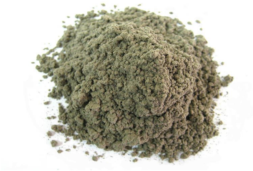
Рисунок 5.1 – Мікронаповнювач на основі подрібненого БСТВ.
