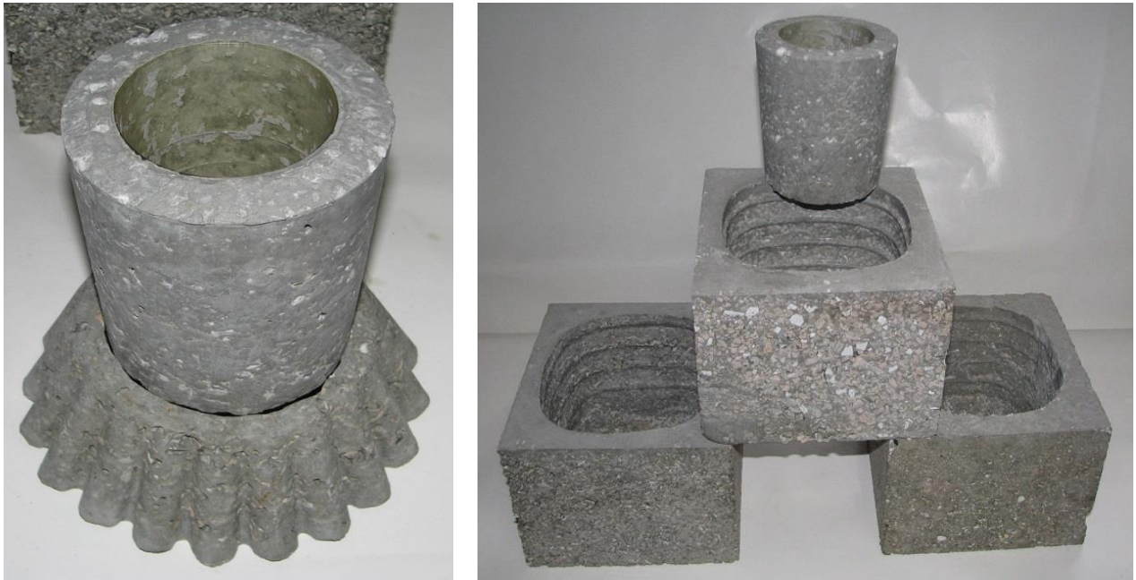
Рисунок 5.19 – Зразки матеріалів, отриманих на основі цементного в'язучого й наповнювачів у вигляді луско-волокнистих силікатмістких відходів.
