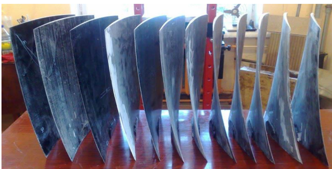
Рисунок 5.6 – Композиційні лопаті для вентилятора аеродинамічної труби на основі епоксидної смоли, армовані базальтовою супертонкою мікрофіброю.
