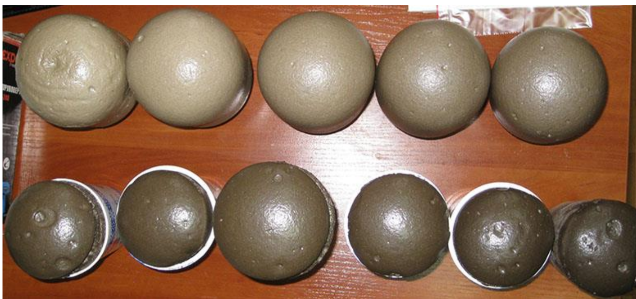
Рисунок 5.13 – Зразки пінополіуретану, армованого базальтовою мікрофіброю з різним ступенем наповнення.
