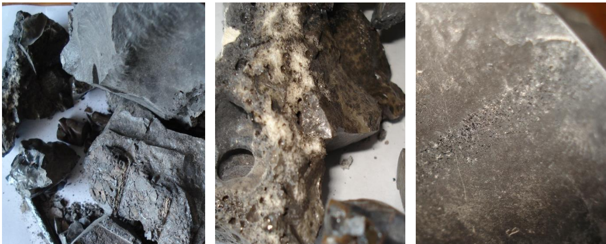
Рисунок 4.4 – Зразки базальтового скла модернізованого силікатом цирконію, отримані методом індукційної плавки.
