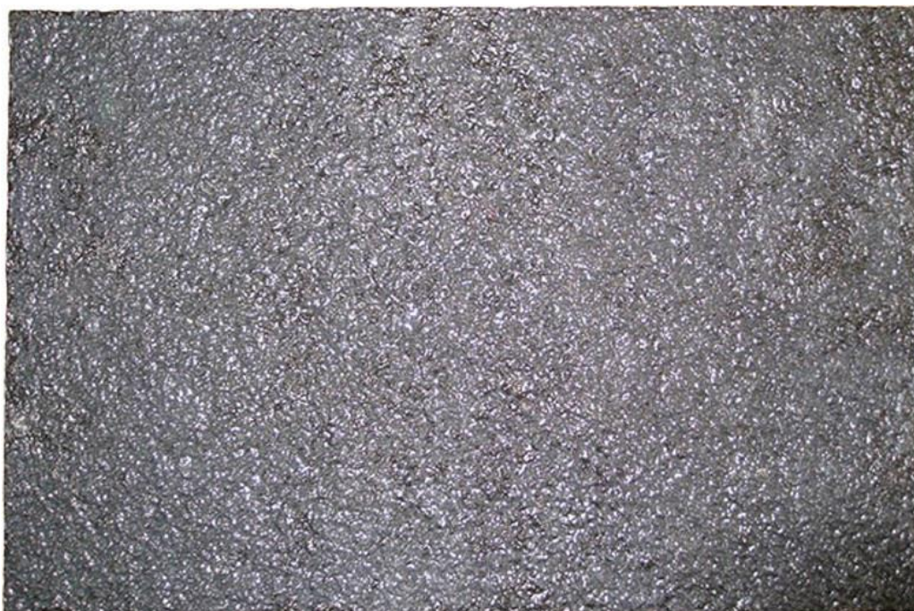
Рисунок 6.5 – Абразивостійке антиковзне покриття виготовлене на основі епоксидної матриці та наповнювача в вигляді базальтових мікросфер.
