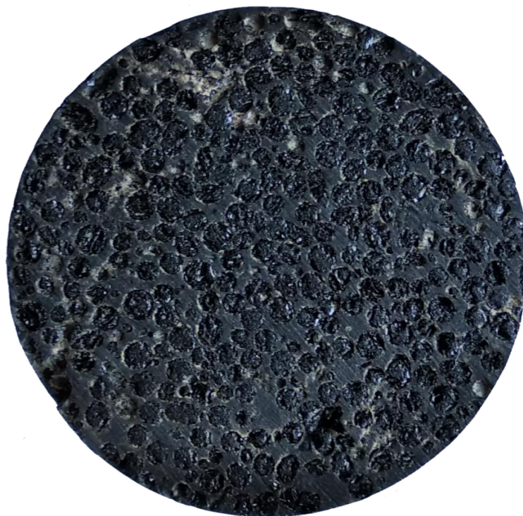
Рисунок 6.9 – Зріз тестового циліндра виготовленого на основі епоксидної смоли та наповненої базальтовими мікросферами ( \Phi=0.42 ).
