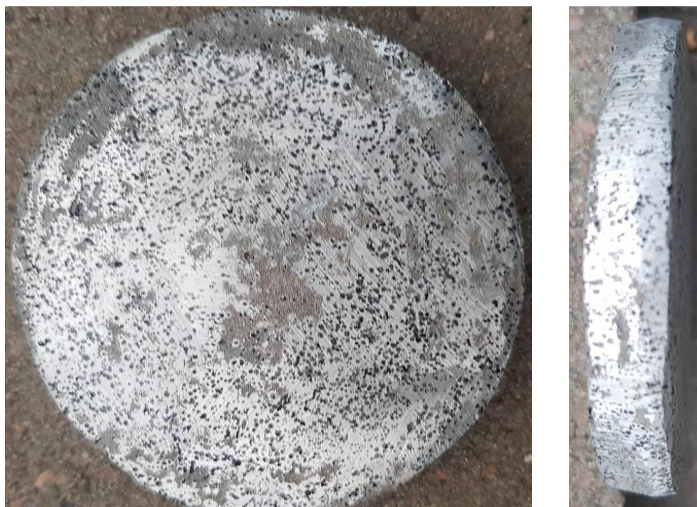
Рисунок 6.10 – Тестовий диск виготовлений шляхом спікання алюмінієвого порошку та базальтових мікросфер.
