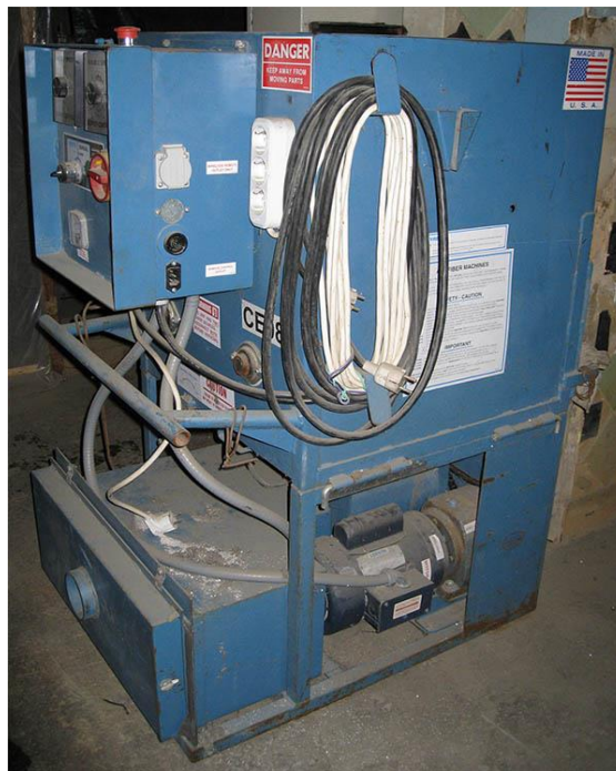
Рисунок 3.1. – Фотографія пневматичного укладача виробництва США нижнього професійного рівня KRENDL500, з продуктивністю укладання волокна 250–350 кг/год.
