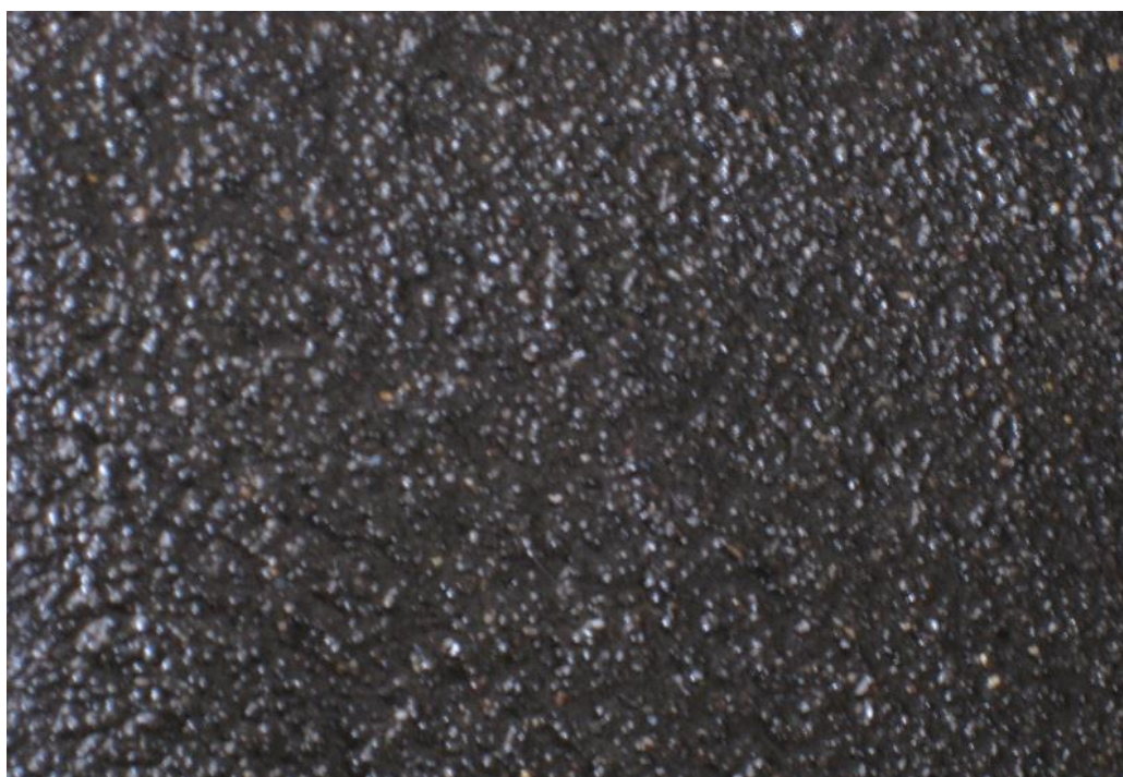
Рисунок 6.6 – Мікрофотографія абразивостійкого антиковзного покриття, на основі епоксидної матриці та базальтових мікросфер для нанесення на металеві та бетонні поверхні.
