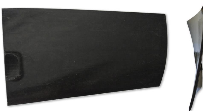
Рисунок 5.5 – Композиційна лопать для вентилятора аеродинамічної труби на основі епоксидної смоли, армована базальтовою супертонкою мікрофіброю.
