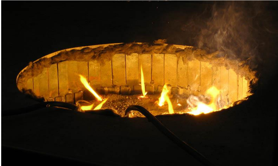
Рисунок 1.3 – Процес холодного старту індукційної печі з мідним водоохолоджуваним тиглем за допомогою графітового порошку.
