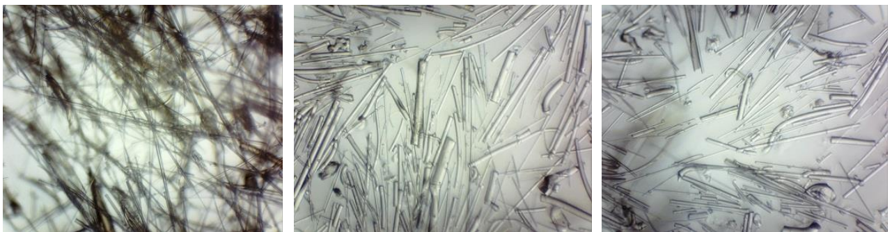
Рисунок 5.2 – Мікронаповнювач на основі подрібненого БСТВ (оптична мікроскопія).
