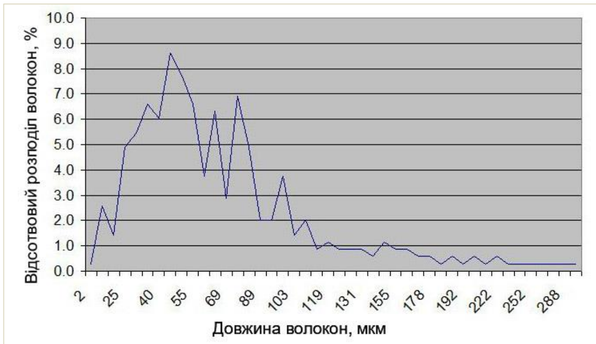
Рисунок 5.3 – Розподіл елементарних волокон за довжиною. Середнє значення довжини волокон 70 мікрон, максимум функції розподілу фібри за довжиною зосереджений у районі 55 мікрон.
