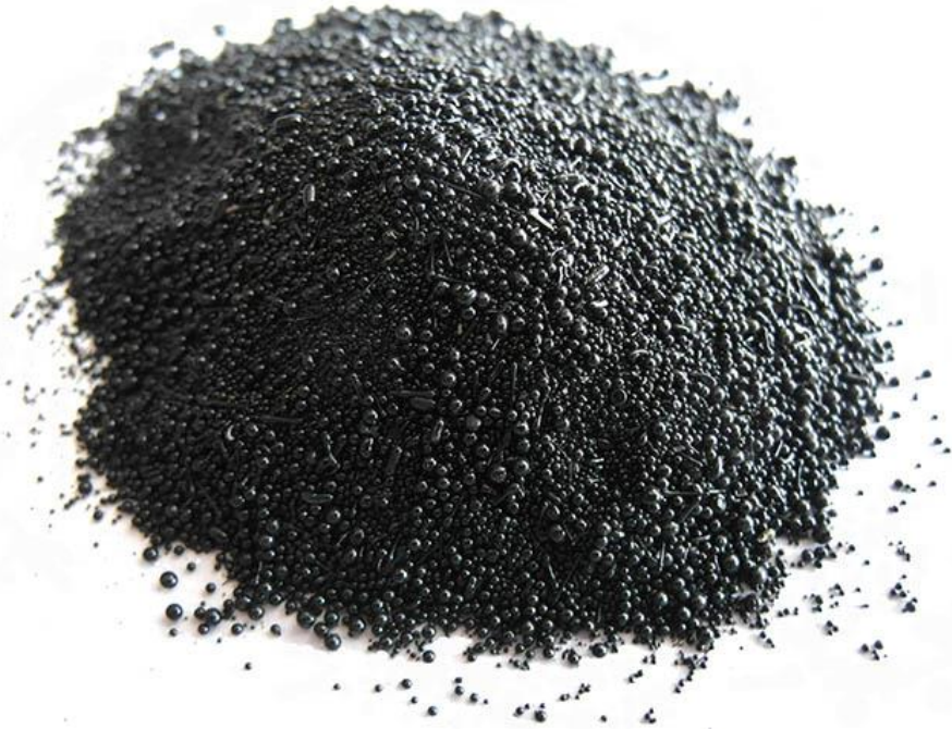
Рисунок 6.1 – Несортовані за розміром та формою базальтові мікросфери, виготовленні методом індукційної плавки.
