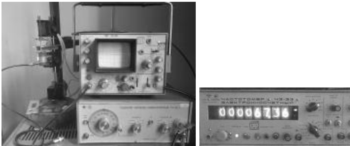
Рисунок 2.7 – Установка для вимірювання швидкості поширення пружних хвиль у стрижнях (розробка Комарова К.А.)
