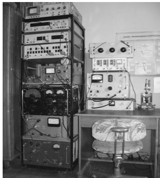
Рисунок 2.2 – Апаратний комплекс для прецизійних вимірювань параметрів пружної хвилі (розробка Безимяного Ю.Г.)
