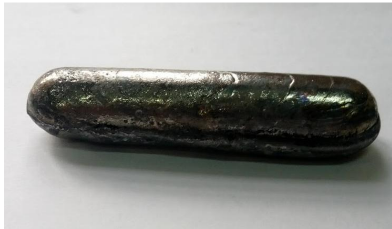
Рисунок 2.9 – Зразок Fe–16%Al після аргонно-дугового переплаву
