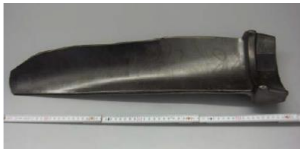
Рисунок 1.18 – Лопатка парової турбіни на основі інтерметаліду Fe 3 Al після обробки
