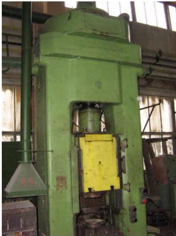
Рисунок 2.6 — Дугостаторний прес ФА-1732 зусиллям 1600 кН
