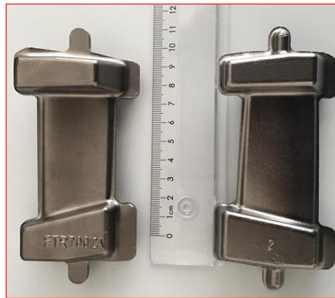
Рисунок 1.17 – Парові турбінні лопатки на основі інтерметаліду Fe 3 Al
