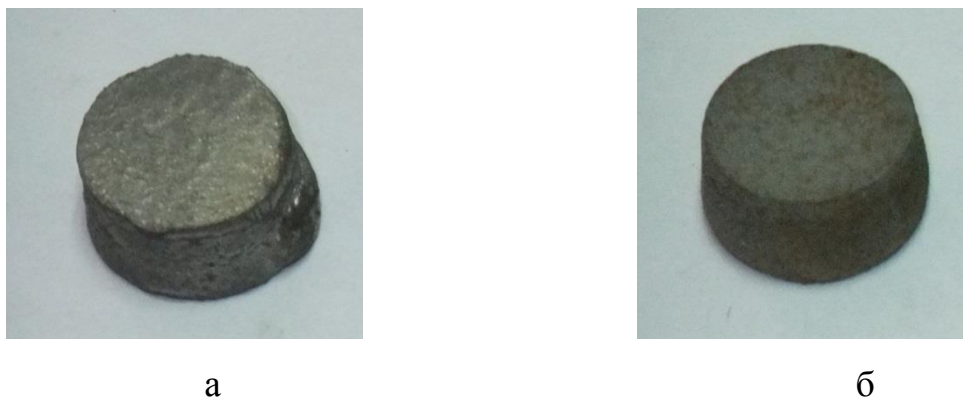
Рисунок 2.4 — Спечені у вакуумі зразки алюмініду заліза Fe-16%Al при температурі 1450^{\circ}\text{C} (а) та 1500^{\circ}\text{C} (б)
