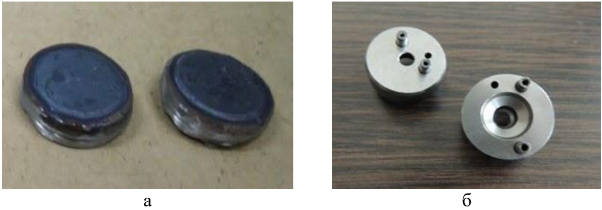
Рисунок 18 – Штампована заготовка (а) та проставка форсунки (б) із композиту Fe–15%Al–2%TiB 2 (мас. %)
