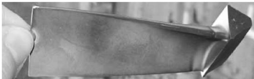
Рисунок 1.12 – Магнетронне покриття із сплаву системи Al-Co-Fe-Cr нанесене на лопатку газотурбінного двигуна [ 55]
