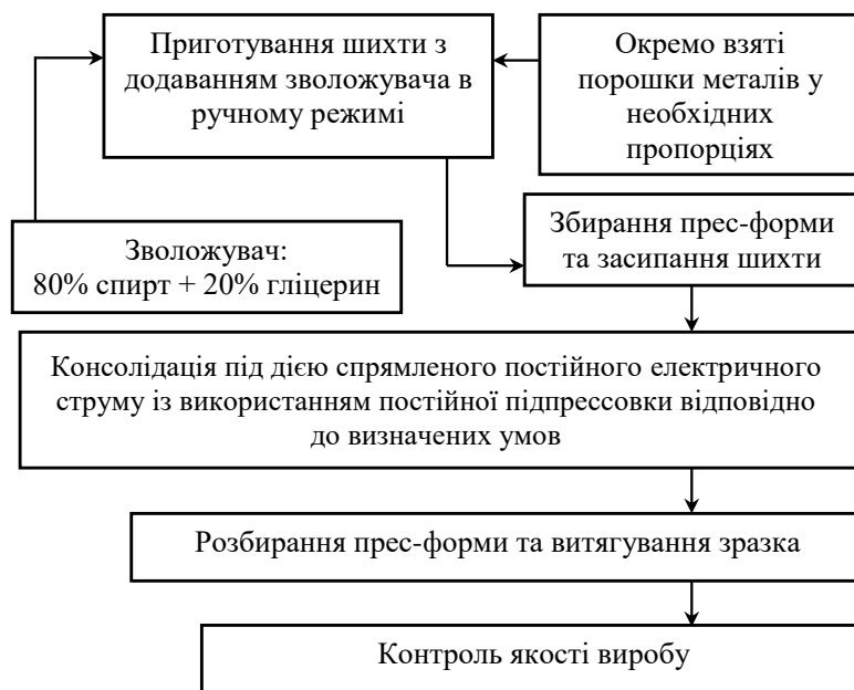
Рисунок. 2 – Схема виготовлення зразків
