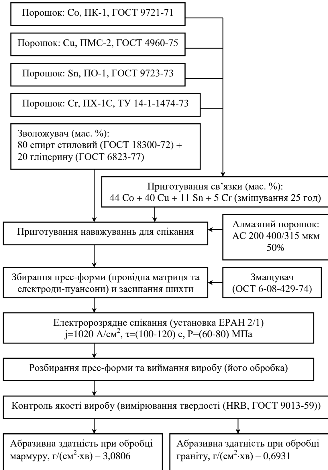
Рисунок 5.4- Схема отримання алмазних елементів із зв'язкою на основі Cu-Sn-Co-Cr на ЕРАН 2/1
