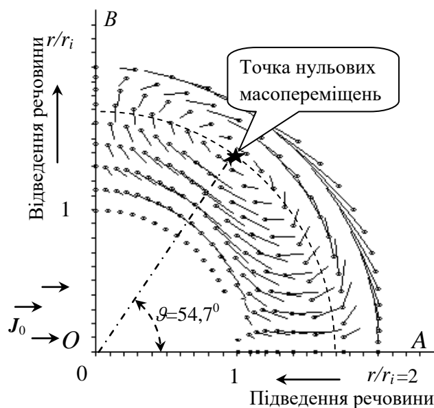
Рисунок 3.15 – Векторне поле напрямку переміщень для k=2 в Cu-Sn
