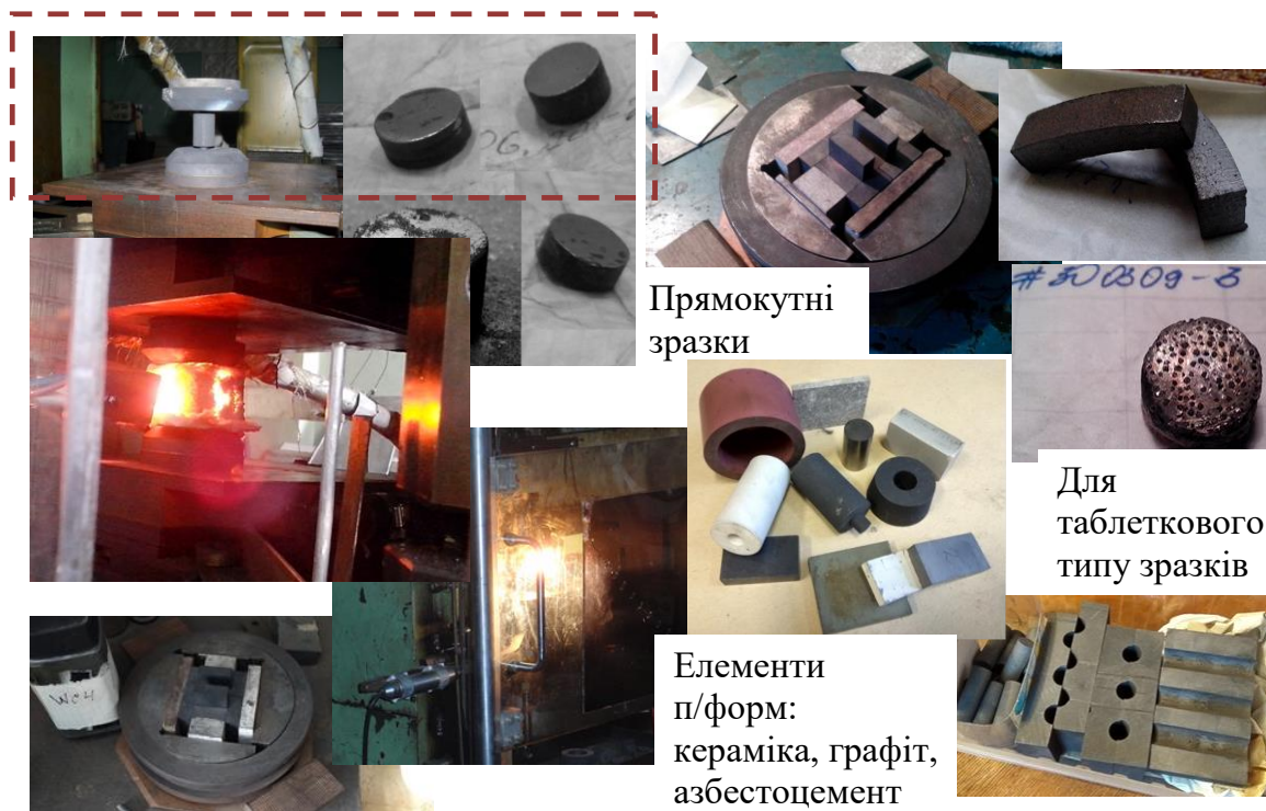
Рисунок 2.2 – Приклад прес-інструменту та виробу алмаз-абразивних сегментів
