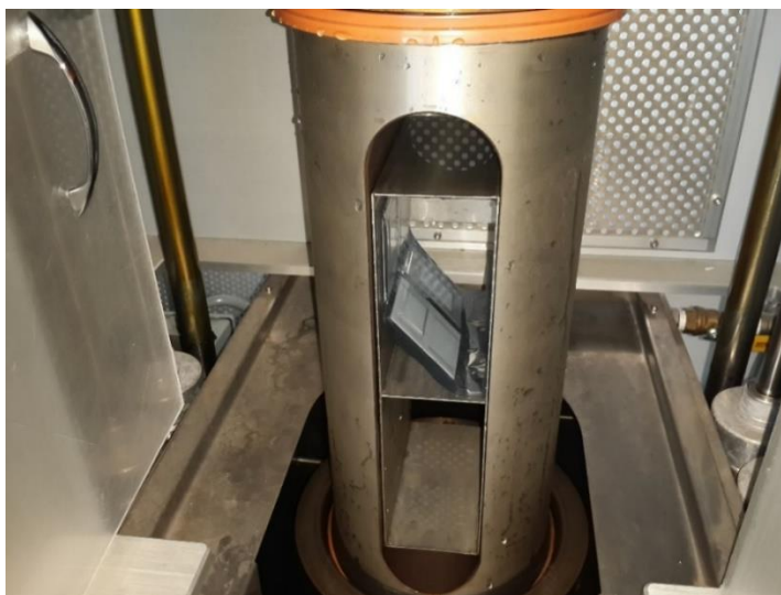
Рисунок 5.25 – Зібрані у пакет плівки \text{BaTiO}_3 та \text{Ni/NiO} у машині холодного ізостатичного ламінування.
