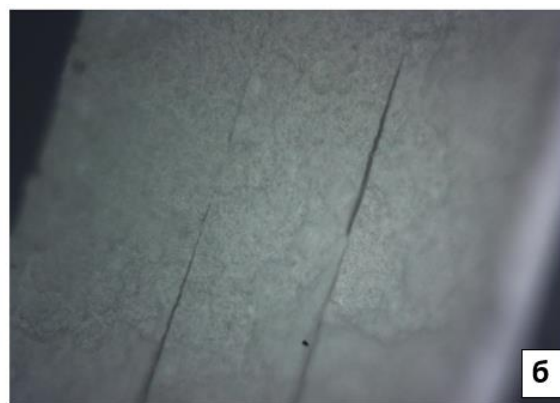
Рисунок 5.26 – Поперечний розріз неспеченої багатошарового композиту ламінованого поетапно (а) та за один прохід (б), після згинання та скручування.
