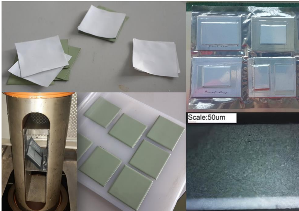
Рисунок 1.37 - Збірка плівок аноду та електроліту одержаних плівковим литтям в заготовку паливного елемента холодним ізостатичним ламінуванням.
