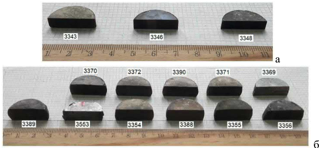
Рис. 3.47. – Зовнішній вигляд зразків (половинок) із суміші Cu-65Cr, отриманих вільним спіканням у вакуумі (а) при температурах 950 (3343), 1050 (3346) та 1150 °С (3348) та ударним ущільненням (б) при температурах 750 (3353, 3370, 3389), 850 (3354, 3372, 3388, 3390), 950 (3355, 3371) та 1050 °С (3356, 3369)
