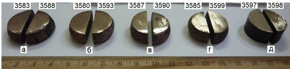
Рис. 3.49. – Загальний вигляд половинок зразків, отриманих ударним ущільненням при температурах 750 (а), 850 (б), 950 (в) та 1050 °С (г), а також рідкофазним спіканням при 1150 °С (д)
