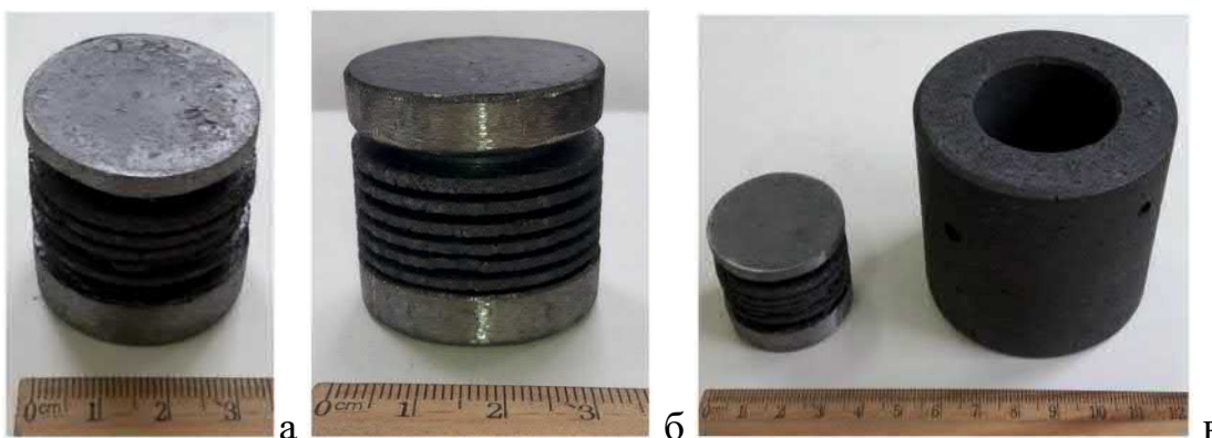
Рис. 3.31. – Вигляд «збірки», що складається з сирого брикету, вставленого в графітову втулку з кільцевими виточками і закритого з торців жароміцними прокладками з молібдену (а) і сталі (б), яка, в свою чергу, вставляється у велику нагрівальну графітову втулку (в)
