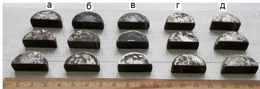
Рис. 3.42. – Зовнішній вигляд зразків (половинок) з порошку Х20Н80, отриманих ударним ущільненням брикетів при температурах 1100 (а), 1150 (б), 1200 (в), 1250 (г) та 1330 °С (д) з ізотермічною витримкою 20 хв. Номери зразків: а – 4229, 4230, 4231 (зверху-вниз); б - 4219, 4226, 4232; в - 4210, 4227, 4233; г - 4218, 4228, 4234; д – 4201'/4205', 4211, 4235
