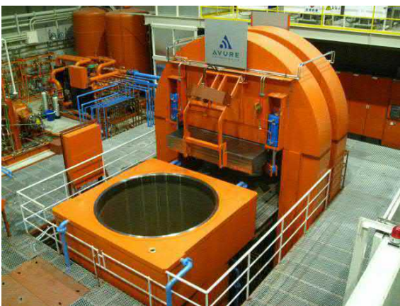
Рис. 1.1. – Найбільша у світі установка ГПІ, яка створена в Японії [22]
