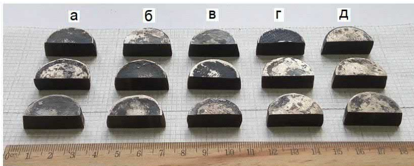
Рис. 3.43.— Зовнішній вигляд зразків (половинок) з порошку \text{Ni}_3\text{Al} (ПХ85Ю15), отриманих ударним ущільненням брикетів при температурах 1100 (а), 1150 (б), 1200 (в), 1250 (г) і 1320 \text{ }^\circ\text{C} (д). Номери зразків: а – 4245, 4247, 4254 (згори донизу); б - 4242, 4248, 4251; в - 4243, 4249, 4252; г - 4244, 4250, 4255; д - 4246, 4253, 4256
