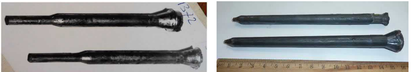
Рис. 6.3. – Зовнішній вигляд довгомірних заготовок ступінчастої та конічної форми із твердого сплаву ВК20, які отримані методом ударного видавлювання у вакуумі
