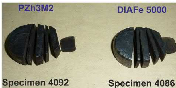
Рис.3.34. – Загальний вигляд зразків із залізних порошків після електроіскрового різання на бруски для механічних випробувань
