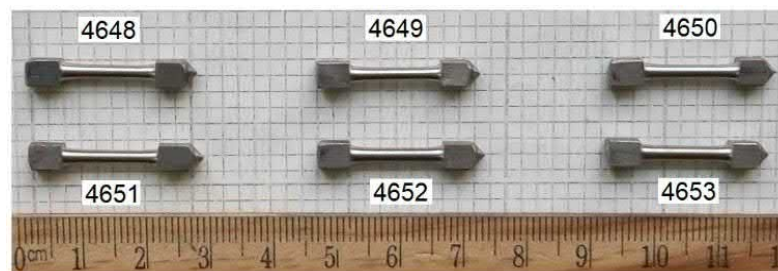
Рис. 3.54. – Зовнішній вигляд типових зразків на розтяг. Тут показано для прикладу зразки з порошку титану ПТМ-1, які отримані ударним ущільненням при температурах 750 (4651, 4648), 850 (4652, 4649) та 950 °С (4653, 4650)
