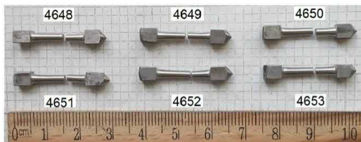
Рис. 4.1.36. – Зовнішній вигляд зразків із дрібнозернистого порошку титану ПТМ-1 після випробування на розтяг (б). Зразки отримані ударним ущільненням сирих (знизу) та підпечених (зверху) брикетів при температурах 750 (4651, 4648), 850 (4652, 4649) та 950 °C (4653, 4650)
