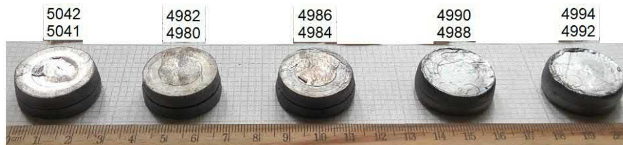
Рис. 3.37. – Вигляд зразків (компактів) після ударного ущільнення за різних температур комбінованих брикетів, що містять електролітичний (знизу) і карбонільний (зверху) кобальт. Температури ущільнення: 550 (5041, 5042), 650 (4980, 4982), 750 (4984, 4986), 850 (4988, 4990) та 950 °С (4992, 4994)
