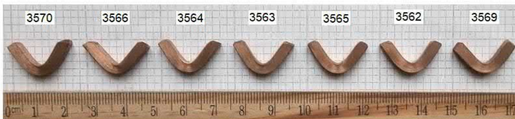
Рис. 4.1.8. - Вигляд випробуваних на ударний вигин зразків, які отримані з порошку ПМС-1 ударним ущільненням при температурах 250 (3570), 450 (3566), 650 (3564), 750 (3563), 850 (3565), 950 1050 °С (3569). Зразок 3570 перед ударним ущільненням був підпечений при 850 °С - 20 хв і мав пористість 29 %
