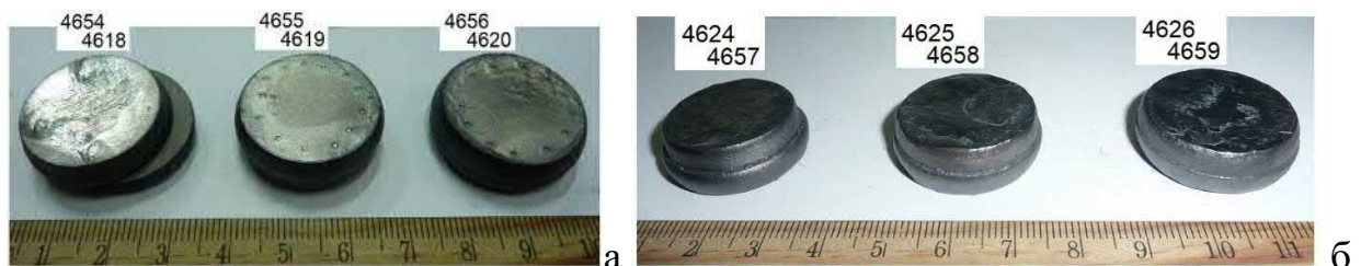
Рис.3.41. - Подвійні зразки з дрібнозернистого порошку титану ПТМ-1, отримані в результаті ударного ущільнення при температурах 750 (4654/4618), 850 (4655/4619) і 950 °С (4656/4620) двох попередньо підпечених при 850 и 900 °С брикетів (а) та отримані ударним ущільненням при температурах 750 (4624/4657), 850 (4625/4658) і 950 °С (4626/4659) попередньо підпечених брикетів при 950 і 1100 °С (б)
