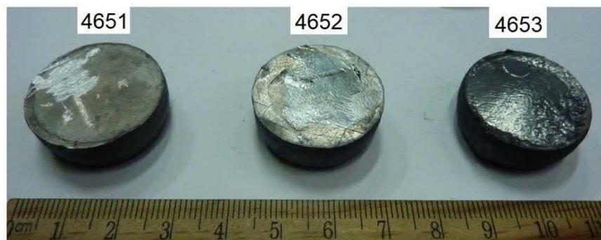
Рис. 3.40. – Одинарні зразки з порошку титану ПТМ-1 після ударного ущільнення сирих брикетів при температурах 750 (4651), 850 (4652) та 950 °С (4653)
