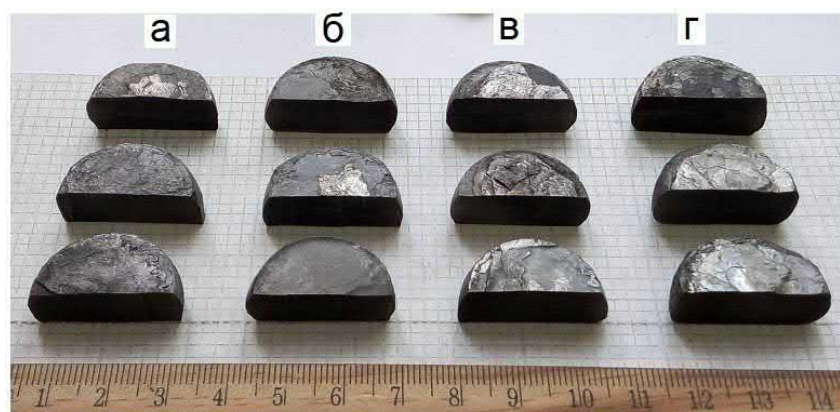
Рис. 3.51. – Зовнішній вигляд зразків Ni_3Al , отриманих ударним ущільненням при температурах 1160 (а), 1220 (б), 1280 (в) та 1330 °С (г). Номери зразків: а - 4447, 4449, 4451 (зверху-вниз); б - 4453, 4455, 4457; в - 4459, 4461, 4463; г - 4467, 4469, 4473
