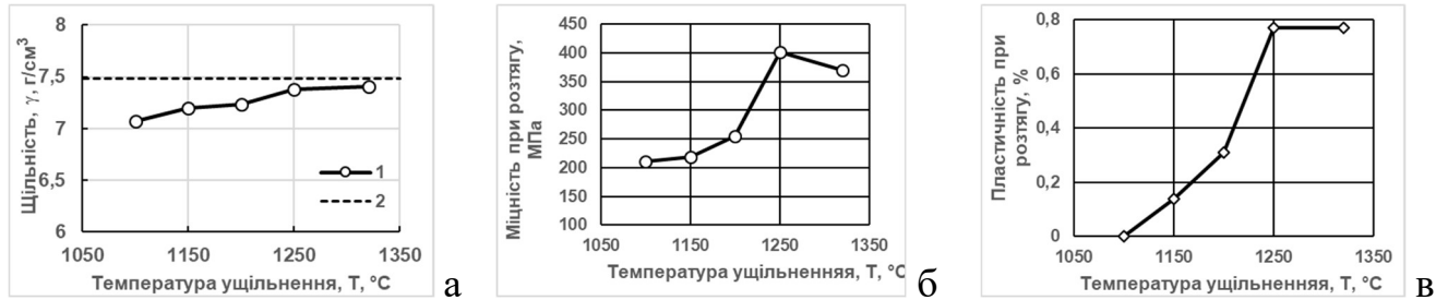
Рис. 20. – Зміна щільності (а), межі міцності (б) та пластичності (в) на розтяг порошкових зразків \text{Ni}_3\text{Al} залежно від температури ударного ущільнення
