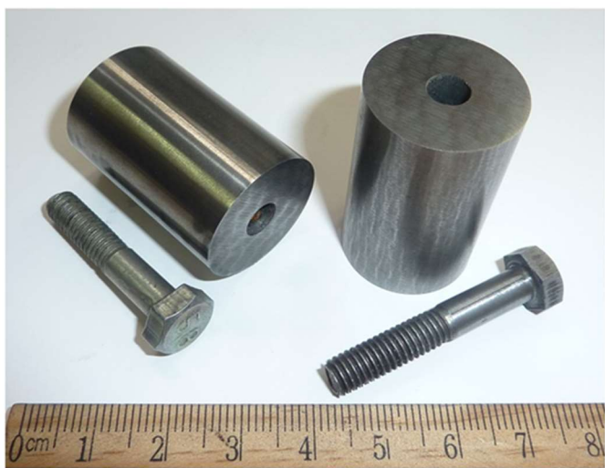
Рис.40. – Зовнішній вигляд заготовок із сплаву ВК20 для висаджування болтів
