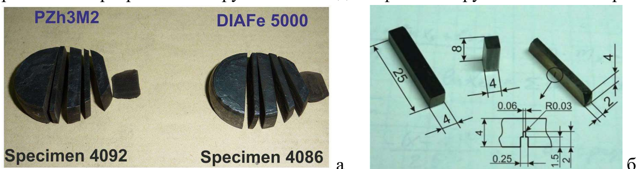
Рис. 9. – Зовнішній вигляд зразків після розрізання на бруски (а) та вид цих брусків після шліфування (б)
