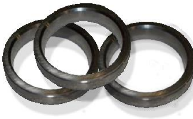
Рисунок 4.17 – Експериментальні зразки сідел клапанів насосів НМШ 5/25-2,5/6 виготовлені із титаноматричного композиту 70 Ti – 30 лігатури % (мас.)
