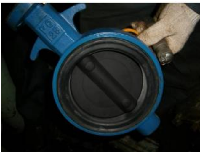
Рисунок 5.24 - Нанесення захисного полімерного покриття на міжфланцеву заслінку гідравлічної системи [216]
