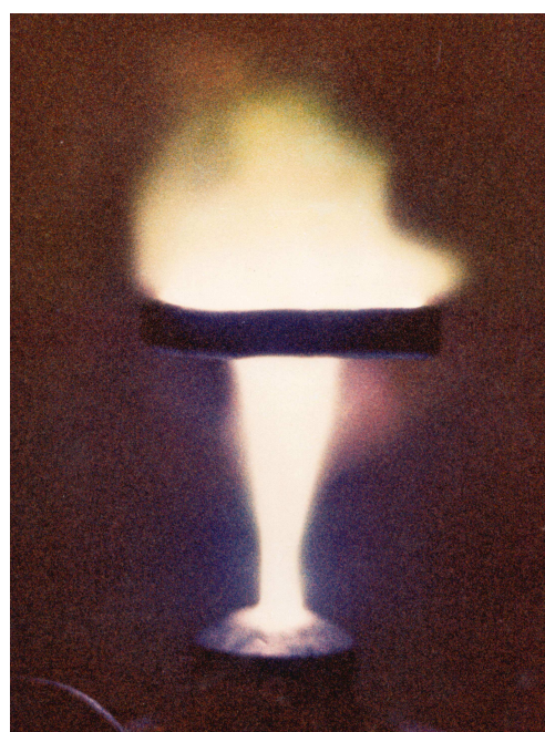
Рис. 1. Разряд для газотермического напыления пленок благородных металлов на поверхности никелевых пластин
