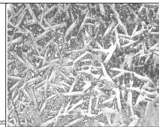
**Рис. 3. Микроструктура сплава состава  $Fe_{51,9}Mo_{11,1}Cr_{26,3}C_{10,7}$ ;  $\times 200$**
