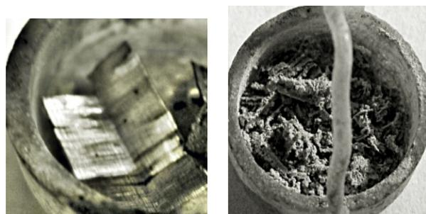
На рис. 2 показан вид исходной фольги псевдосплава до воздействия на неё кислорода воздуха и состояние псевдосплава после окисления. Фольга переходит в порошокобразное состояние, состоящее из оксидов элементов.
