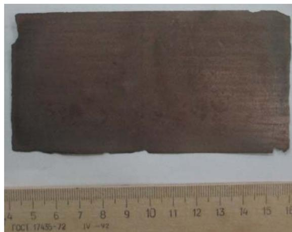
**Рисунок – Припой из  $\text{Cu}_3\text{P}$  в виде фольги**
