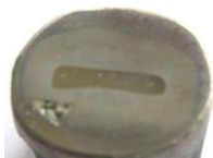
Рис. 1. Спеченный макрокомпозит чугун – твердый сплав
