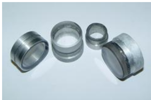
Рис. 1. Паяные образцы кварц – АМц.
