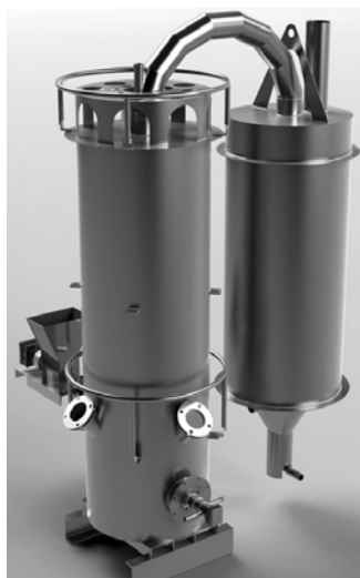
Рис. 1. Модернізована установка для виробництва термографеніту (ТРГ).
