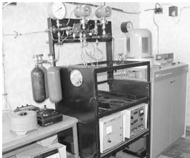
Рис. 1. Загальний вигляд установки по вивченню водень-сорбційних властивостей
