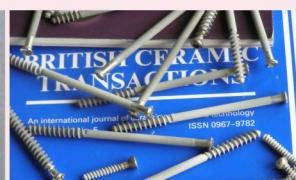
Гвинти з біоактивним керамічним покріттям, нанесеним детонаційним методом на різьбові частини шурпів
