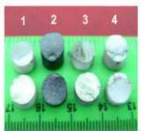
Види руйнування при зсуві керамічних зразків, з'єднаних тиском з застосуванням металевих наноплівочок: 1 – часткове руйнування по кераміці; 2, 4 – руйнування по кераміці; 3 – руйнування по межі плівка-припій
