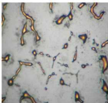
Плівка золота завтовшки 300 нм нанесена на кристал природного алмазу після відпалення у вакуумі при 1150 °C протягом 10 хв (оптичний мікроскоп, x400)
