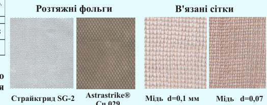
При ударі блискавки в літак низькі значення коефіцієнтів теплопровідності та високі значення питомого електропору вуглеplastickів приводять до значних ушкоджень ПКМ у вигляді наскрізних отворів, розшарування на значній площині і, як наслідок, відбувається винесення шарів у потоці повітря під час польоту літака.
