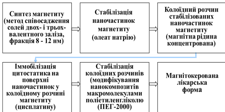
Рис. 2.69. Схема технології одержання магнітокерованої лікарської форми [160]
