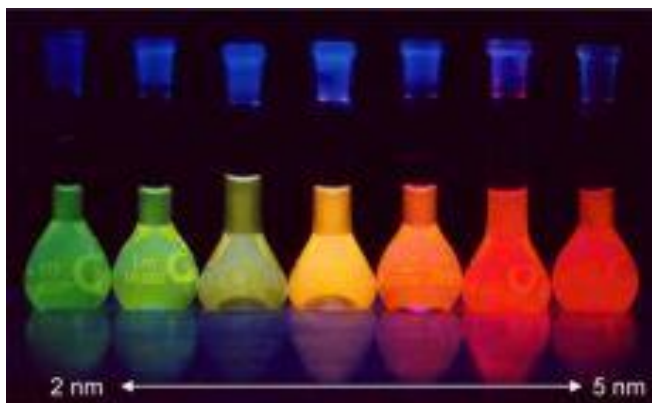
Рис. 1.2. Флюоресценція зависей колоїдних частинок CdTe різних розмірів (від 2 до 5 нм; напрям – зліва направо ; всі колби освітлюються згори синім світлом однакової довжини хвилі) [8]
