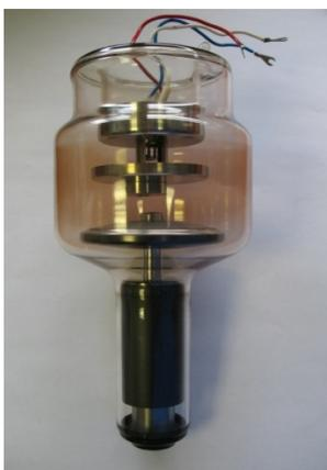
Рис. 1. Рентгеновская трубка аппарата «Проскан-2000».
