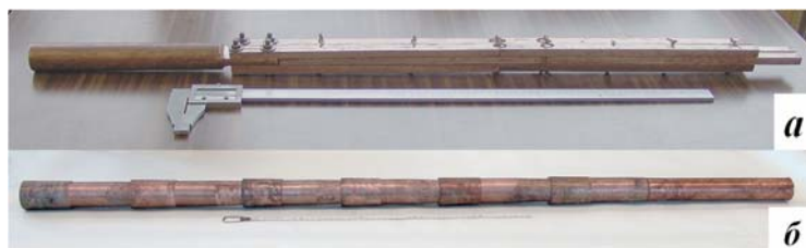
Рис. 2. Экспериментальные расходуемые электроды, собранные из спеченных штабиков (а) и слитков индукционной плавки (б).
